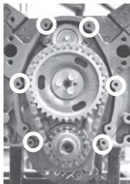
Tapa Distribución 6 tornillos 6 Bolt Timing Cover
